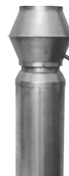
Standrohr 500 mm doppelwandig innen isoliert mit Alu-Lamellmatte 25 mm
