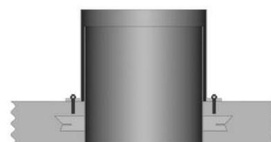
Futterrohr einbetoniert Montage direkt auf Beton
