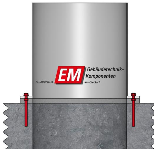
Montage auf Betonrohrsockel mit Nivelliermuttern
