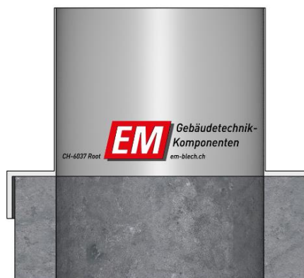
Montage über Betonrohrsockel
